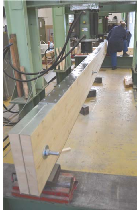
Abbildungen 5 und 6: Befestigen der Verstärkungsplatten mittels Hilti-Schussnägeln
