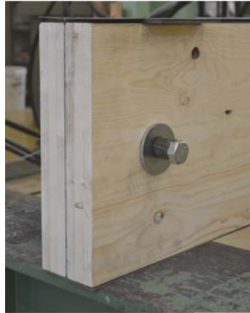
Abbildung 2: Hybridträger im Montagezustand
