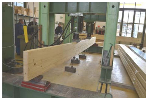
Abbildung 4: Vierpunktbiegeversuch des Holzprobekörpers
