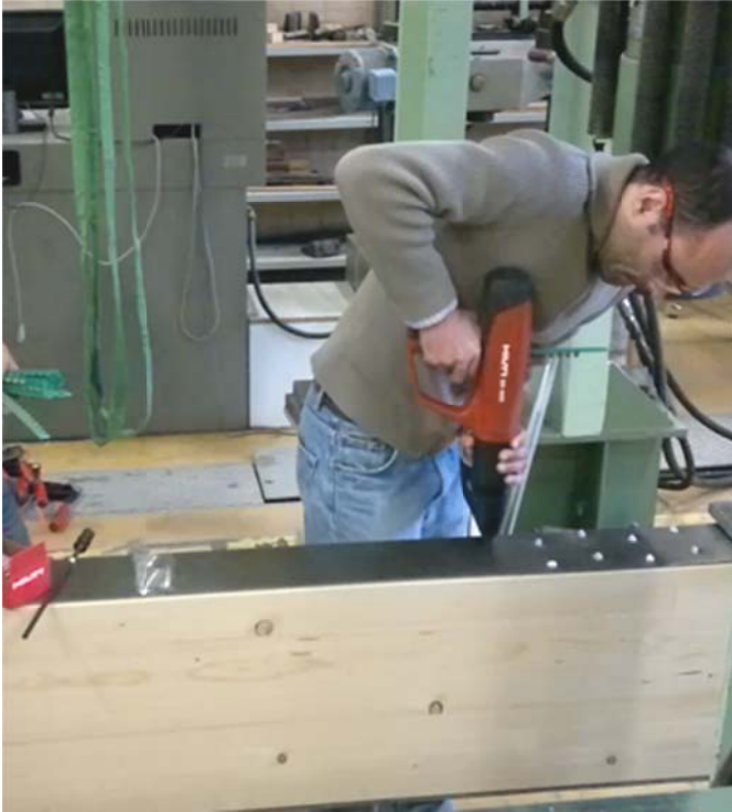
Abbildungen 5 und 6: Befestigen der Verstärkungsplatten mittels Hilti-Schussnägeln
